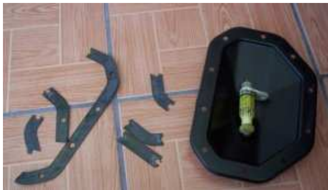
Figura No. 9 Carter, junta y engrane sucios
