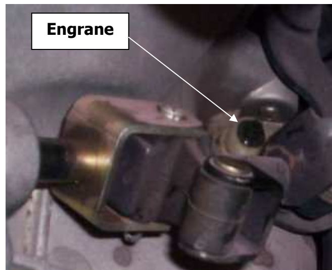
Figura No. 5 Engrane del velocímetro al descubierto
