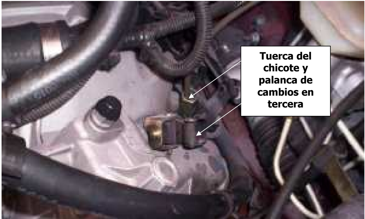
Figura No. 4 Aspecto del chicote del velocímetro
