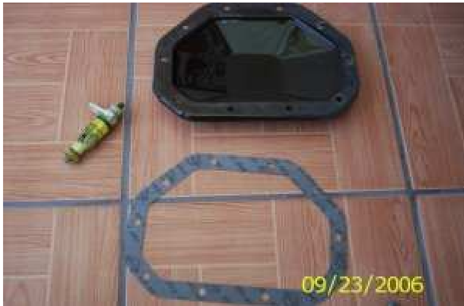
Figura No. 10 Carter y engrane listos para la limpieza y junta
