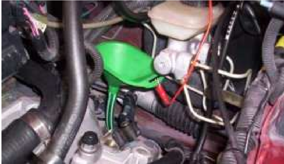
Figura No. 15 Colocación del embudo
