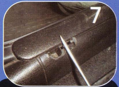
Para tener acceso al relevador debemos retirar el estribo interior del lado del copiloto, para ello necesitaremos un desarmador plano con el que vamos a botar una pequeña tapa que cubre el primer tornillo.
