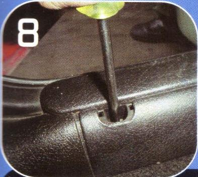
Con una punta Thorx 25, retiramos el tornillo que fija el estribo interno a la carrocería.
