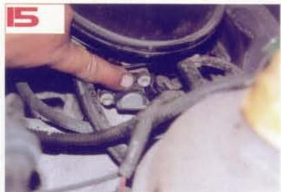
Éste es el sensor TPS, el cual se encuentra dañado y se debe cambiar.
