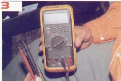
3 El voltímetro es un instrumento utilizado por técnicos y mecánicos en diferentes áreas; con él se pueden obtener lecturas de la cantidad de corriente en voltaje, amperaje, o miliamperaje, según sea necesario.
