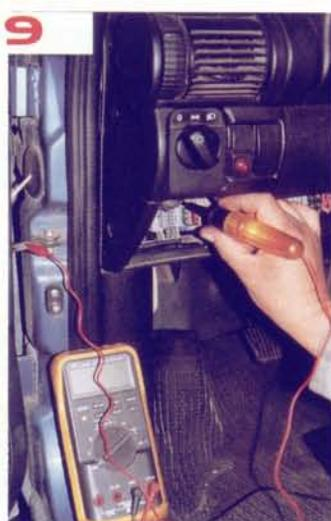
10. La línea de 12 volts que no tiene amperaje es la que vamos a utilizar para el autodiagnóstico, como podrás observar, la lámpara no se prende.
