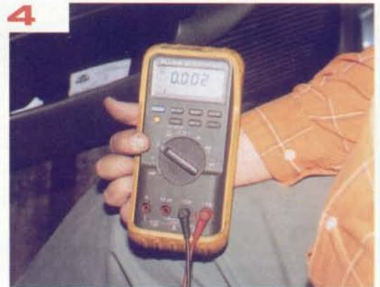
4 Prendemos el voltímetro en voltaje o corriente directa. En la pantalla aparecerá una "V" con dos líneas sobre ella.
